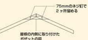
屋根の内側に取り付けたガゼットの図
